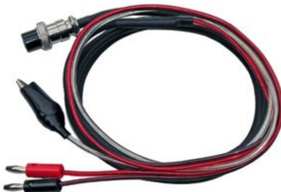
Дифференциальный осциллографический щуп предназначен для получения осциллограммы напряжения относительно сигнальной "массы", что позволяет существенно снизить эффект наложения "наводок" на полезный сигнал через общую "массу". Это достигается путём съёма сигнала между положительным и отрицательным пробниками дифференциального осциллографического щупа.
