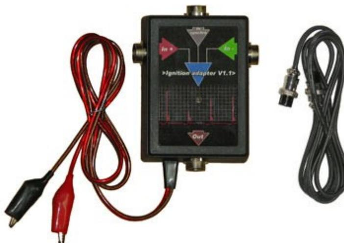
Основной функцией адаптера диагностики систем зажигания Ignition Adapter является согласование выходного сигнала высоковольтных ёмкостных датчиков с аналоговыми входами осциллографа. В свою очередь, высоковольтные ёмкостные датчики служат для съёма осциллограмм напряжения во вторичных цепях систем зажигания, что необходимо для проведения диагностики систем зажигания.
