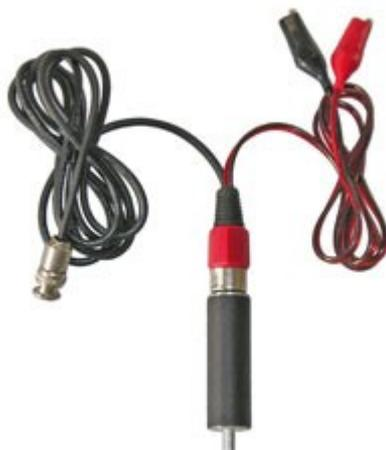
Датчик разрежения Dх служит для преобразования разрежения / давления на входе штуцера датчика в напряжение. Датчик применяется при проведении диагностики механической части двигателя. Оценка состояния механики двигателя осуществляется по графикам пульсаций разрежения во впускном коллекторе двигателя, по графику пульсаций давления газов в картере двигателя и по графику пульсаций давления отработавших газов на выходе из выхлопной трубы диагностируемого автомобиля.
