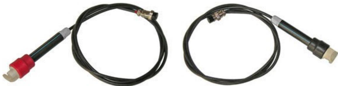
Высоковольтный ёмкостной датчик Cx служит для съёма осциллограммы выходного напряжения катушки зажигания, что необходимо при проведении диагностики систем зажигания. Датчик подключается к входу "In+" адаптера диагностики систем зажигания Ignition Adapter. Применяется при проведении диагностики классической системы зажигания с катушкой зажигания расположенной вне корпуса распределителя зажигания.
